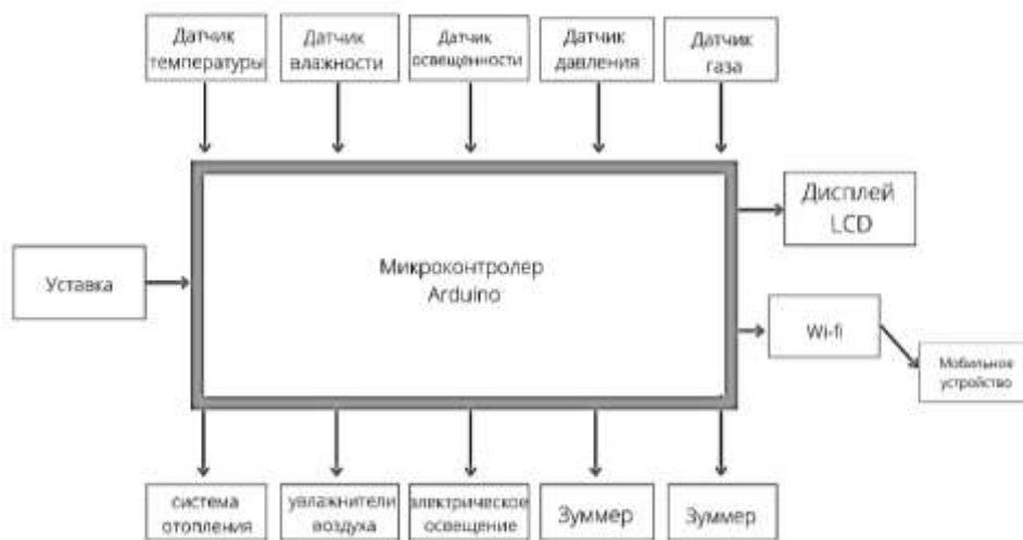
Рисунок 1 - Структурная схема комплексной контрольно-измерительной системы контроля климатических параметров специализированного помещения
