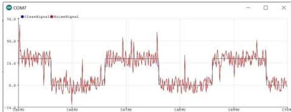
Рис. 7 - Суммарный сигнал «полезный сигнал плюс шум»
