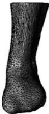
Рисунок 1. Поверхность стопы, заданная посредством триангуляции треугольниками в процессе сканирования
